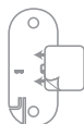
Supporto di montaggio a parete per pulsante senza fili con cuscinetto adesivo opzionale
